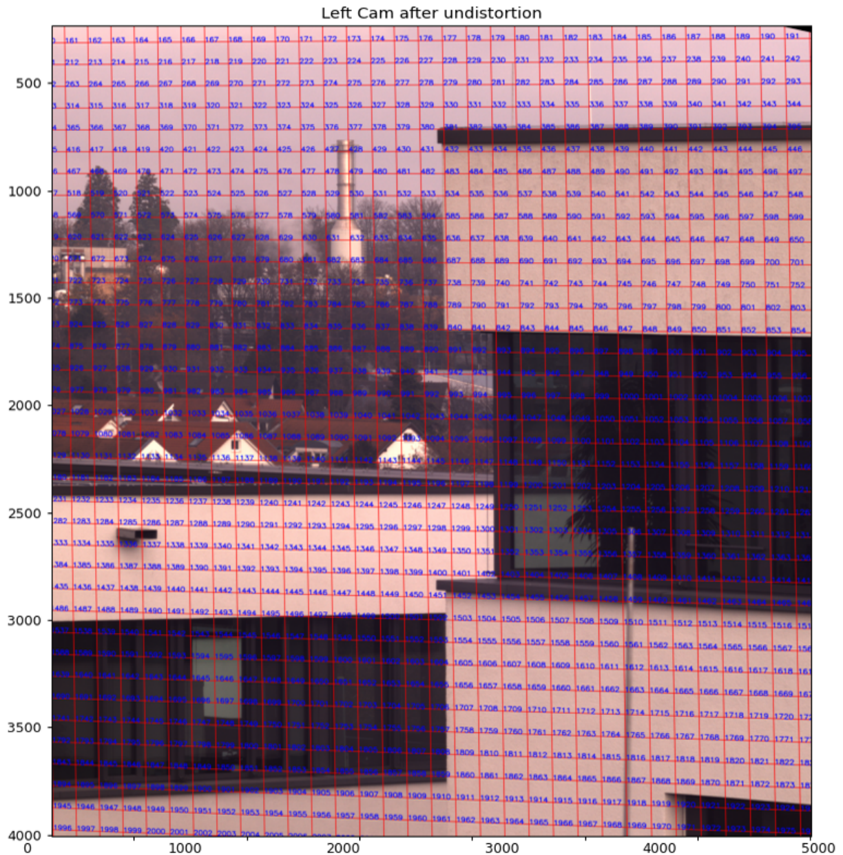
Abb. 25: Entzerrte Aufnahme, nach Stereo Kalibrierung. Das Gitternetz visualisiert die Korrektur nach der Entzerrung und die Zahlen (blau) geben die Pixelkoordinaten im Bild wieder.
