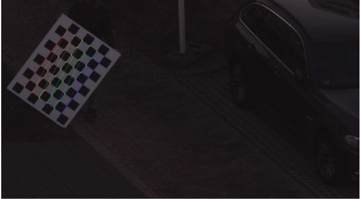
Abb. 24: Automatisierte Ecken- und Kantendetektion für die Kamerakalibrierung Die detektierten Schnittpunkte farblich gekennzeichnet.
