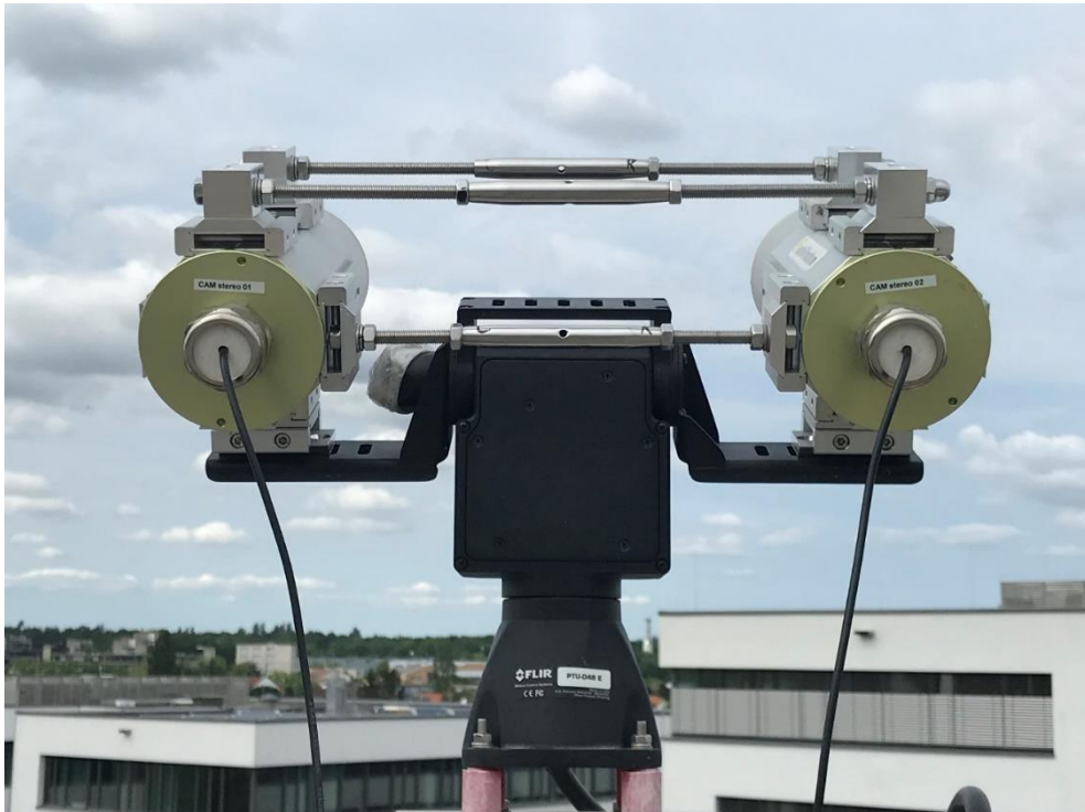
Abb. 19: Stereokamera paar auf dem Schwenkneigekopf.
